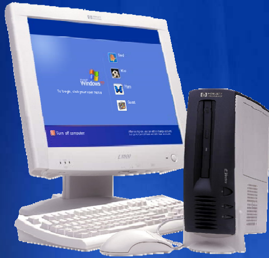
台式电脑 (AC供电, 主机、显示器和输入各部分独立)
