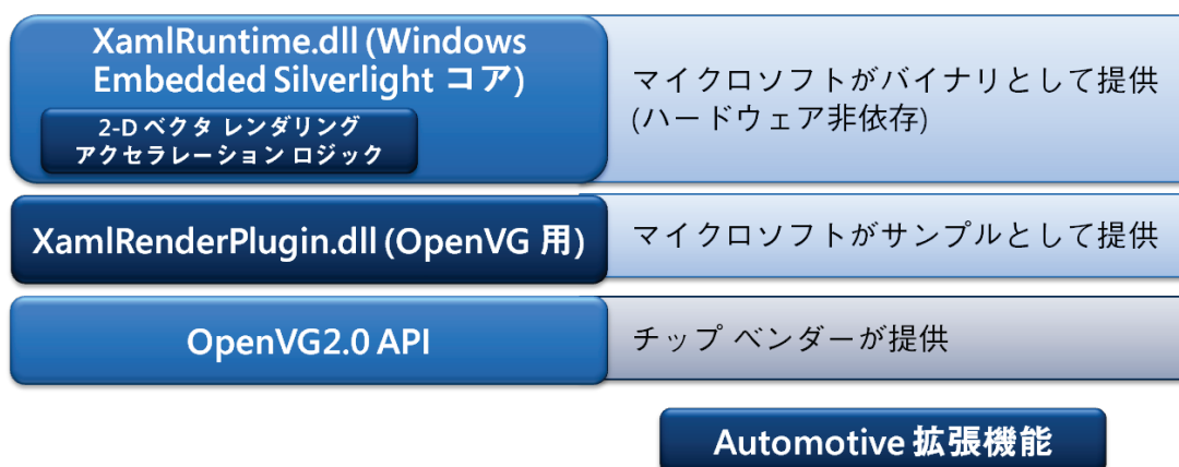
図 23. Windows for Silverlight Embedded の詳細
