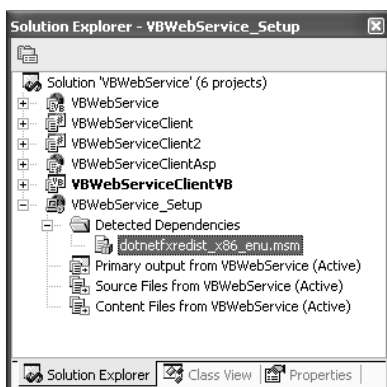
Abbildung 5.29: In einem Setup-Projekt wird standardmäßig die Datei dotnetfxredist_x86_enu.msi eingefügt, die die Dateien zur Installation des .NET Framework enthält.
