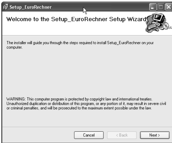
Abbildung 5.26: Erstes Dialogfenster bei der Installation mittels msi-Datei – Der hier markierte Begrüßungstext kann in Visual Studio .NET über die Eigenschaften des entsprechenden User Interface Dialog editiert werden.
