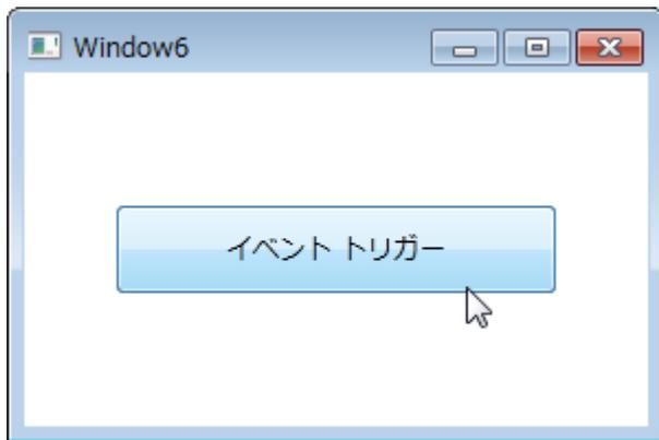
アプリケーションを実行し、マウスをボタンの上に移動する (MouseEnter) と、幅が 200px に変化し、マウスをボタンの外側に移動すると (MouseLeave)、100 px に戻ります (実際には、元に戻るのではなく、100 px に再設定しているだけです)。
