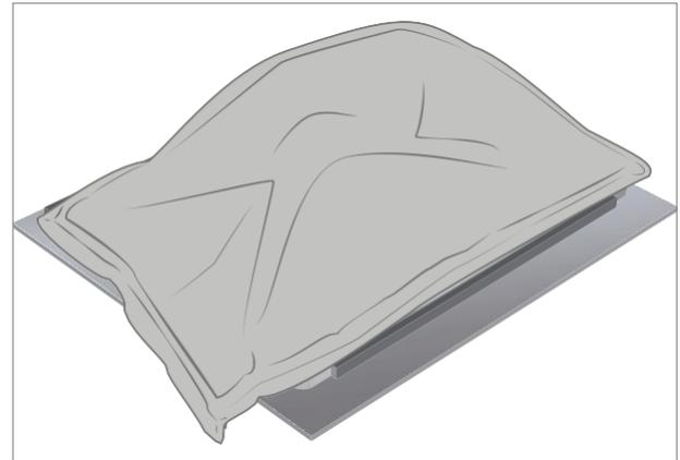
Legen Sie den 14 kg schweren Stahlschrotbeutel für 1 Minute auf das Gerät Bond
