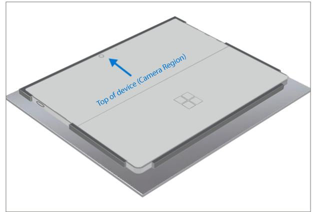
Legen Sie das Display des Geräts mit der Seite nach unten in den Kleberahmen
