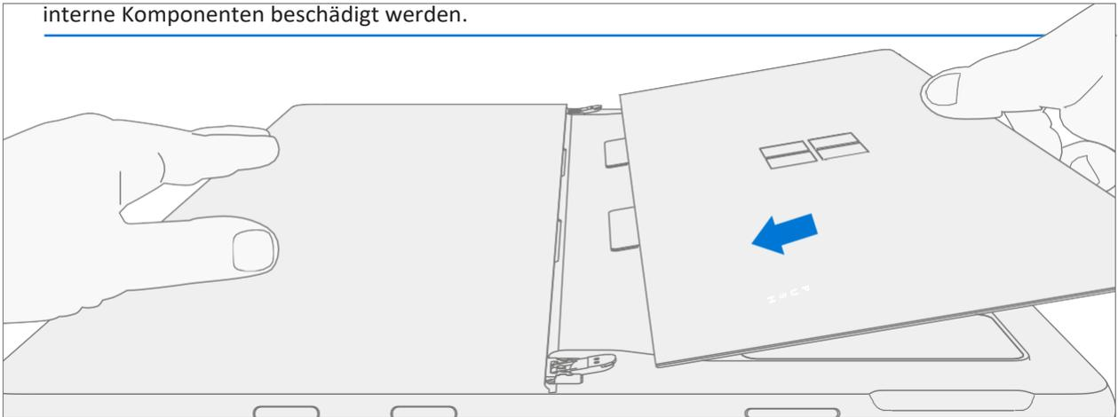
2. **Stecken Sie die äußere Lippe des Scharniers in den Ständer** – Drehen Sie den Ständer mit den Fingern an der Unterseite des Ständers und dem Daumen auf der Oberseite leicht um die Achse, wie unten gezeigt. Der Ständer sollte sich um ~5 Grad drehen, um die Außenlippe des Scharniers zu erfassen. Schieben Sie den Ständer in Richtung des Geräts.
