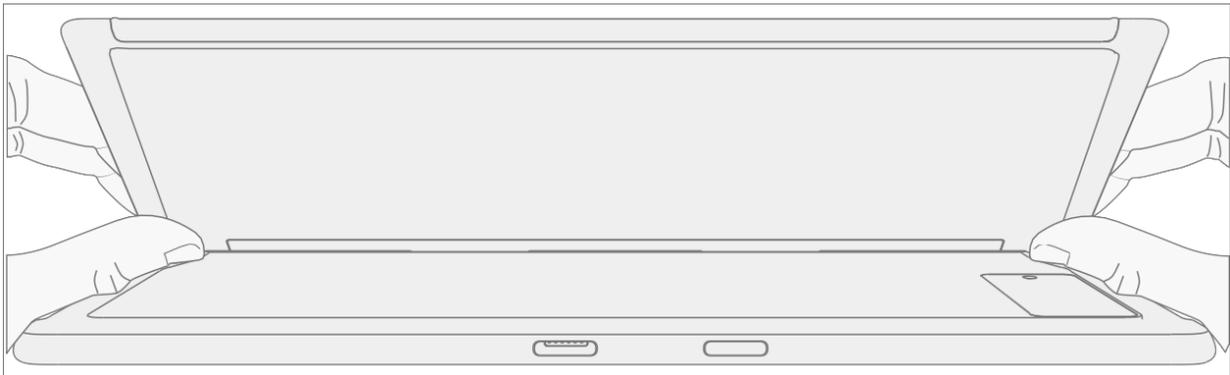
5. **Schraubensicherung auf Schrauben auftragen** – Neue Schrauben mit Loctite 649 Aktivator bürsten. Lassen Sie die Schrauben nach dem Auftragen des Aktivators 2 Minuten einwirken, bevor Sie sie am Gerät zusammenbauen.
