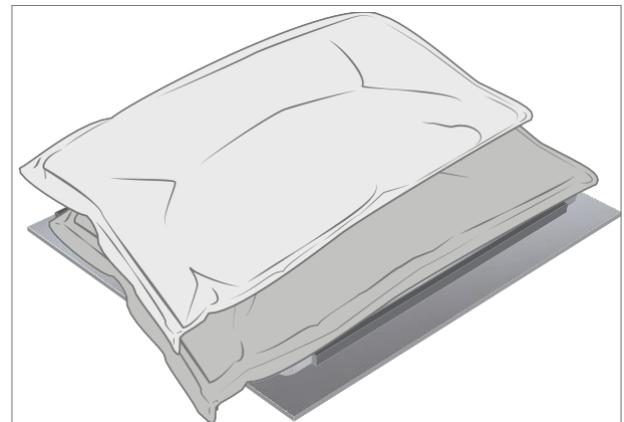
Den zweiten 9 kg schweren Stahlschrotsack an die Oberkante des Gerätes schieben 3 Minuten einwirken lassen
