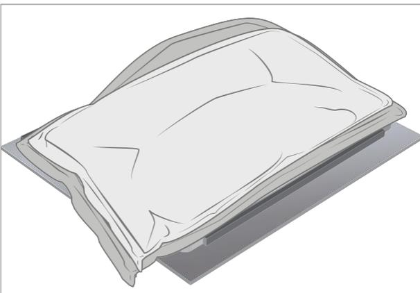
Legen Sie den zweiten 9-kg-Stahlschrotsack für 5 Minuten auf den 14-kg-Sack Bond
