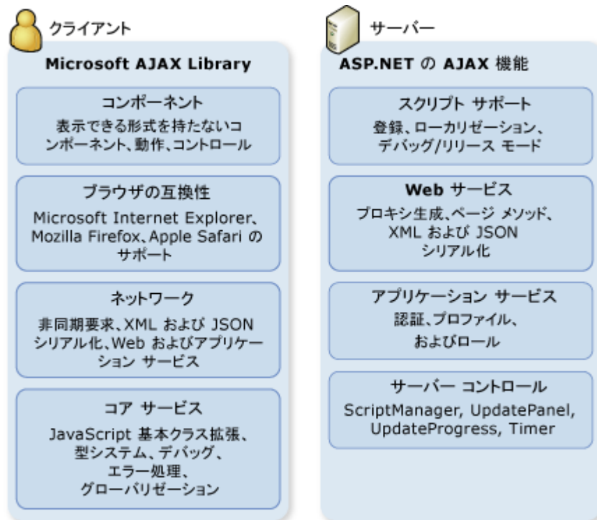
図. ASP.NET AJAX サーバーおよびクライアントのアーキテクチャ
