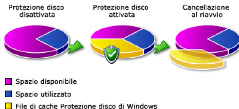
Figura 7: illustrazione dell'utilizzo del file di cache quando Protezione disco di Windows è attivata.
