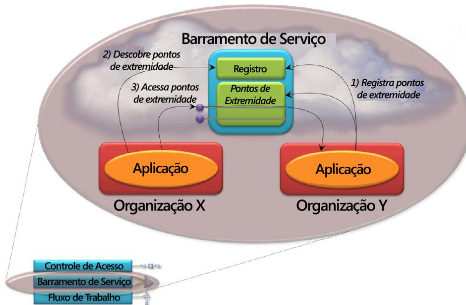
Figura 9: O Barramento de Serviço permite a um aplicativo registrar pontos de extremidade e depois fazer outros aplicativos descobrir e usá-los para acessar seus serviços.
