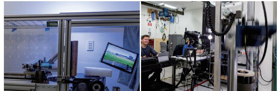
さまざまな装置により、デバイスが 2 メートル以上の高さからカーペットやコンクリートなども落とされ、衝撃がシミュレートされます。高速撮影カメラがデバイスにフォーカスし、あらゆる衝撃の影響を捕らえようとしています。
