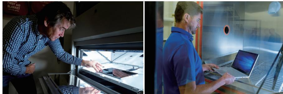
貨物船内や炎天下の自動車、アウトドアなど現実世界の厳しい条件をシミュレーションしたテストを実験室で行います。極めて高温や低温、高い湿度、塩分を含む霧が発生する状況で何時間もテストを行い、製品の内外に腐食の兆候がないかを検査します。
