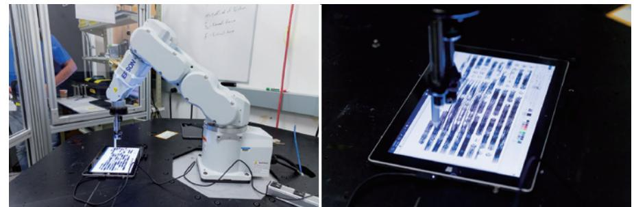
ロボットの腕が Surface ペンを握り、Surface の画面上で水平線と垂直線の格子を描画しています。数ヶ月間にわたりロボットは描画作業を繰り返し続けます。
