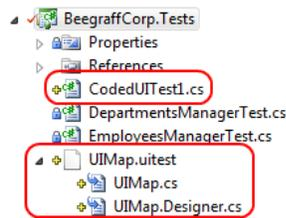
Le fichier **CodedUITest1.cs** est le point d'entrée du test d'interface graphique. C'est ce dernier qui contient l'appel vers les différentes étapes du test :
