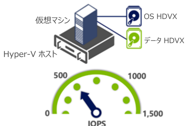
図 19 – IOPS の上限が記憶域 QoS によって 500 に設定されている集中的なワークロードを含む VM
