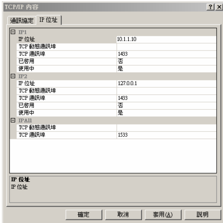
圖 1-8-3C 修改預設的 TCP/IP 的傾聽埠為 1533
