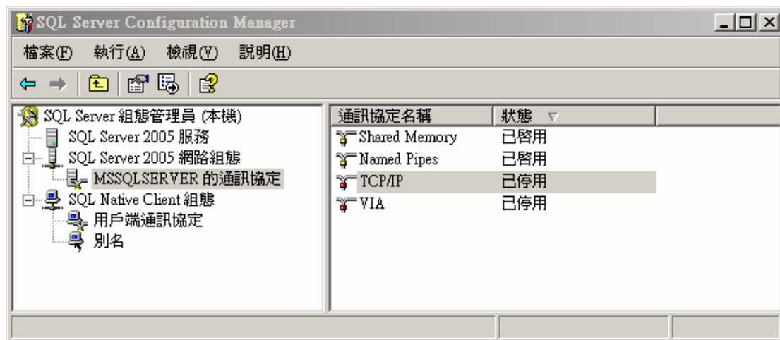
圖 1-8-3A 影響前端使用 telnet 測試的通訊協定設定
