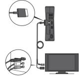
感謝您購買 Xbox 360® 高解析 VGA AV 端子線,用於連接您的 Xbox 360 主機與 VGA (CRT 顯示器、LCD、或高畫質電視螢幕,包括電腦螢幕。本端子線也可以連接到類比音效 擴大器,但僅能與 Xbox 360 視訊遊戲家庭娛樂系統搭配使用。
