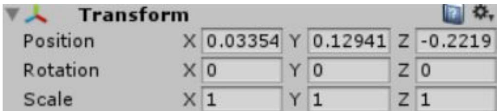
3) En haut à droite du transform cliquez sur le petit rouage et sélectionner "reset" ce qui va positionner votre Tabouret en 0,0,0 et mettre la rotation à 0,0,0 puis le "scale" à 1,1,1.
