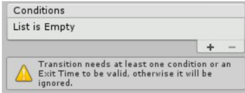
En effet notre transition n'a plus aucune condition pour s'effectuer. Pour le moment on ne lui a pas attribué d'évènements et on vient de lui retirer "Has exit time".
