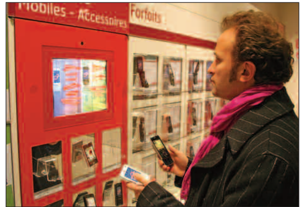
Ce présentoir a détecté, grâce à la RFID, les deux mobiles que ce client venait de prendre en main. L'écran affiche alors un comparatif technique.
